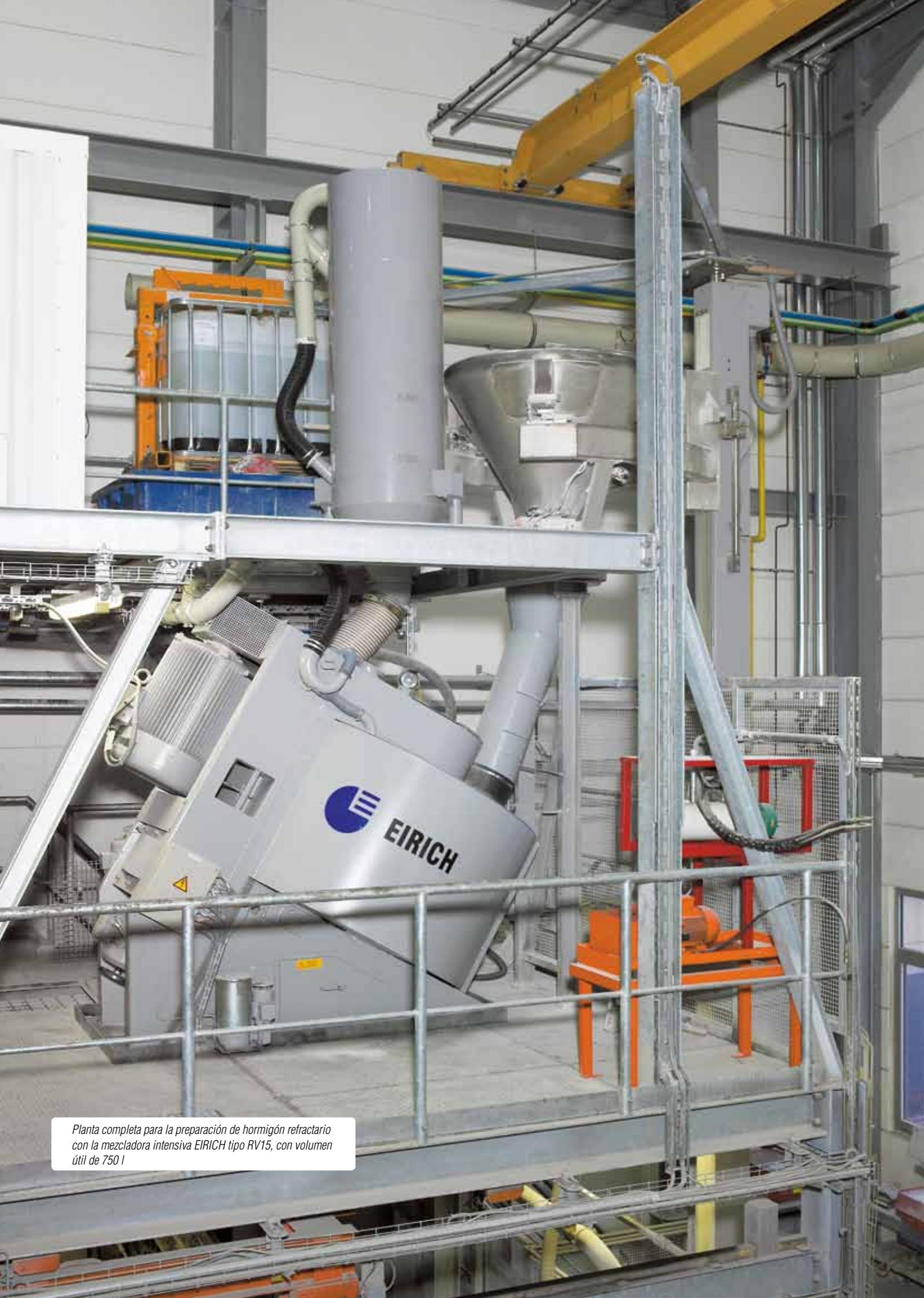
*Planta completa para la preparación de hormigón refractario con la mezcladora intensiva EIRICH tipo RV15, con volumen útil de 750 l*
